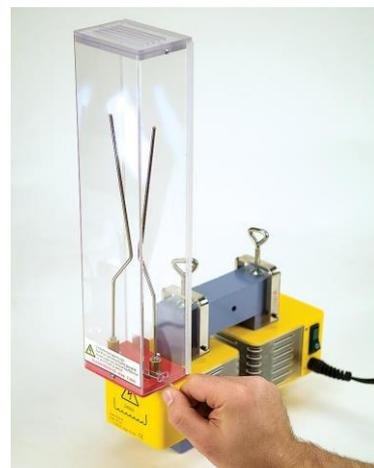
Fig. 3 Décharge d'étincelles le long des électrodes à cornes
