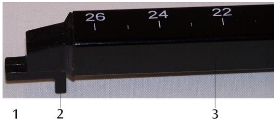
Sonde de champs magnétiques : 1 sonde de Hall tangentielle (direction Z), 2 sondes de Hall axiale (direction X), 3 supports
