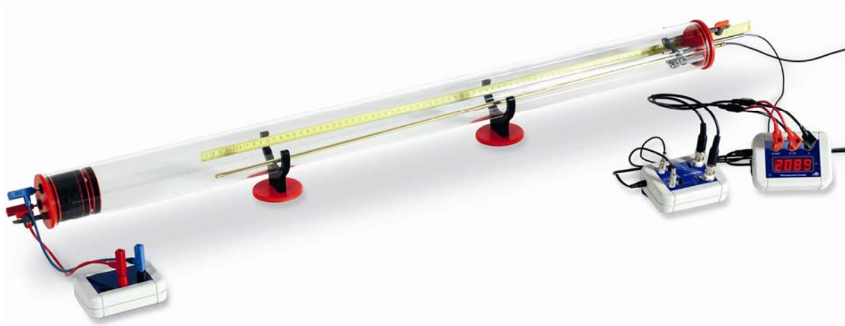
Fig. 1 Détermination de la vitesse sonique à partir de la durée d'une impulsion
