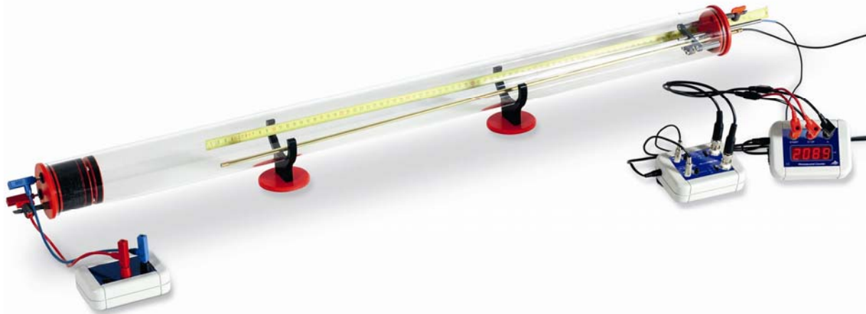
Fig. 1 Determinazione della velocità del suono sulla base della durata di un impulso sonoro
