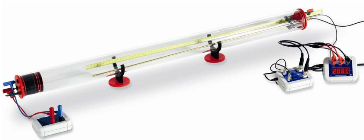
Fig. 1 Determinação da velocidade do som a partir do tempo de percurso de um impulso sonoro
