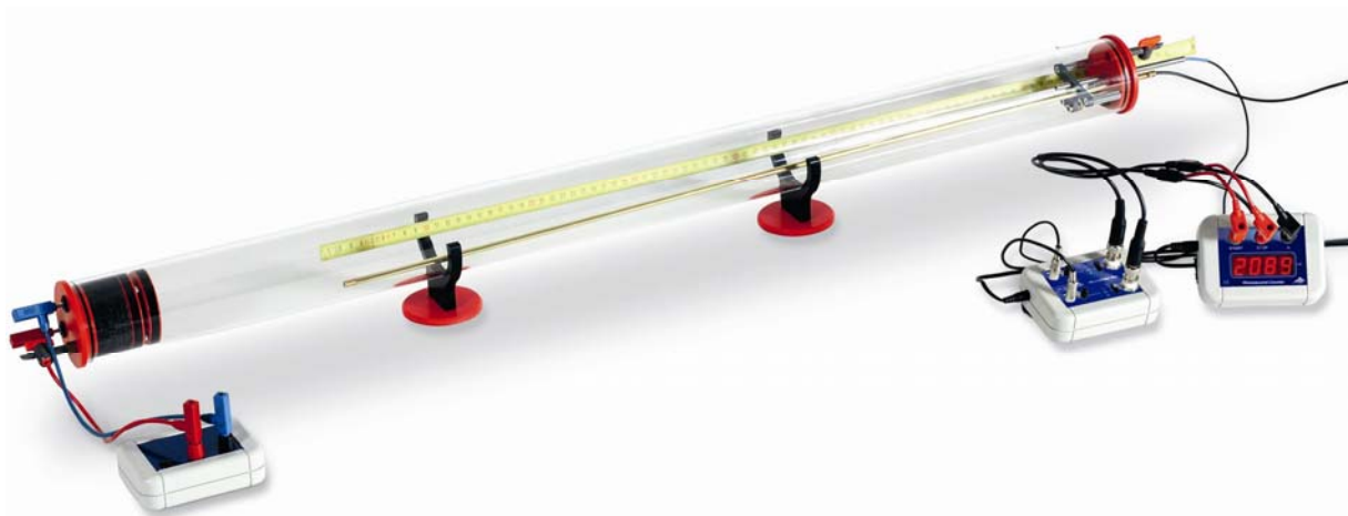
Fig. 1 Bestimmung der Schallgeschwindigkeit aus der Laufzeit eines Schallimpulses
