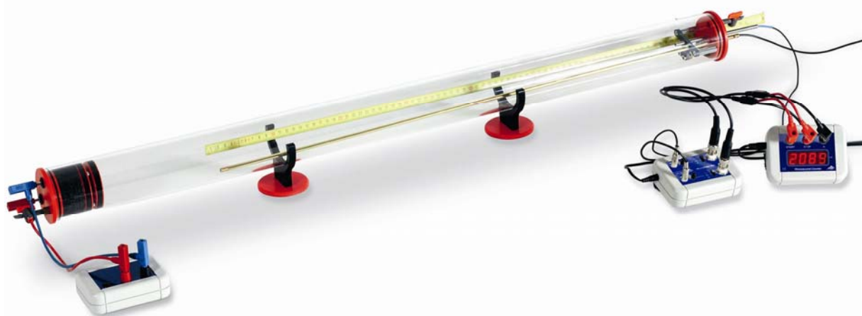
Fig. 1 Determinación de la velocidad del sonido a partir del tiempo recorrido de un impulso de sonido
