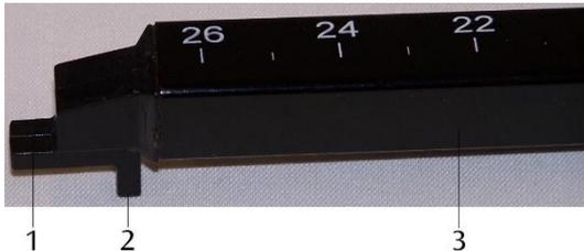
Sonda de campo magnético: 1 Sonda de Hall tangencial (Dirección z), 2 Sonda de Hall axial (Dirección x), 3 Soporte
