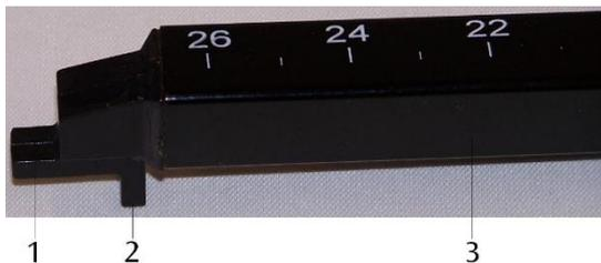
Sonda magnetica: 1 Sonda Hall tangenziale (direzione z), 2 Sonda Hall assiale (direzione x), 3 Supporto
