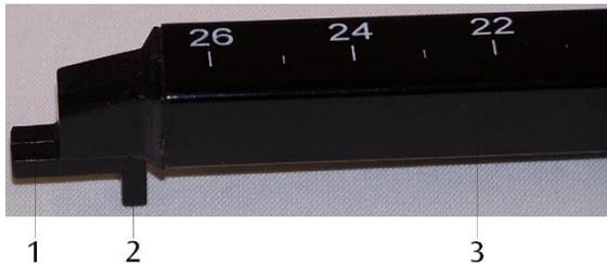
Sonda de campo magnético: 1 Sonda de Hall tangencial (Sentido z), 2 Sonda de Hall axial (Sentido x), 3 Portador
