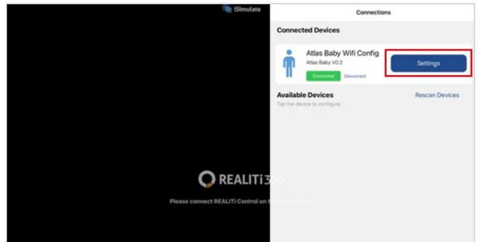
5. **Cambie el nombre SSID de Wi-Fi:** Aparecerá la configuración Wi-Fi de Atlas y podrá personalizar el nombre de la red Wi-Fi en consonancia con el enrutador. Asegúrese de que el nombre SSID y la contraseña de Wi-Fi concuerdan con su enrutador Wi-Fi.
