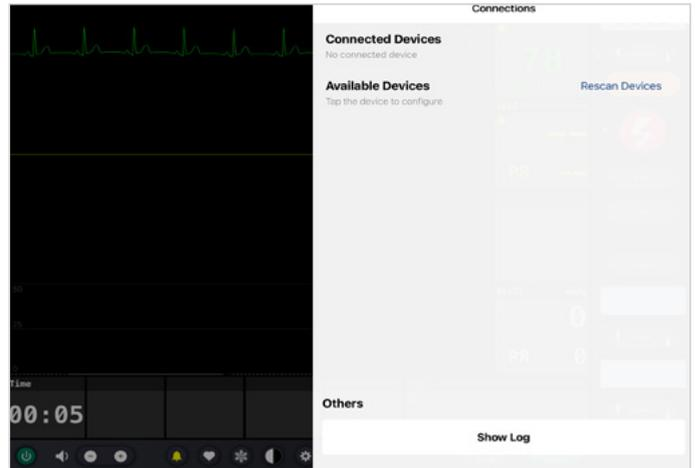
10. Tocca 'Rescan Devices'. Tra i dispositivi disponibili, selezionare 'Atlas' toccando 'Connect Device'. L'Atlas connesso verrà calibrato automaticamente. I manichini simuleranno il polso carotideo.
