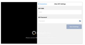
**6.** Après avoir saisi le SSID et le mot de passe Wi-Fi souhaités, appuyez sur « Save Settings » pour pouvoir appliquer les modifications à la configuration Wi-Fi.
