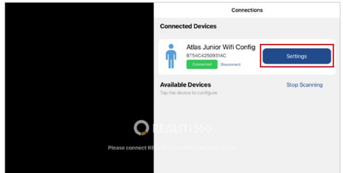
5. Wi-Fi SSID 이름 변경: Atlas Wi-Fi 설정이 표시되어 라우터와 일치하도록 Wi-Fi 네트워크 이름을 사용자 지정할 수 있습니다. Wi-Fi SSID(이름)와 비밀번호가 모두 Wi-Fi 라우터와 일치하는지 확인합니다.
