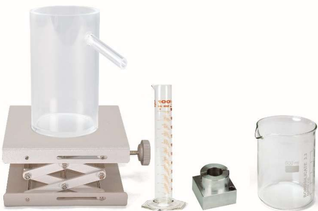
Fig. 1: Aufbau zur Bestimmung des Volumens eines unregelmäßigen Körpers
