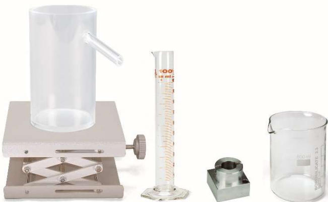
Fig. 1: Montaje para la determinación del volumen de un cuerpo de forma irregular
