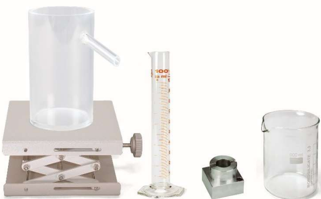
Fig. 1 : Montage expérimental pour définir le volume d'un corps de forme irrégulière
