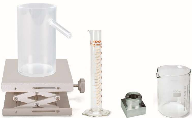
Fig. 1: Montagem para determinação do volume de um corpo irregular
