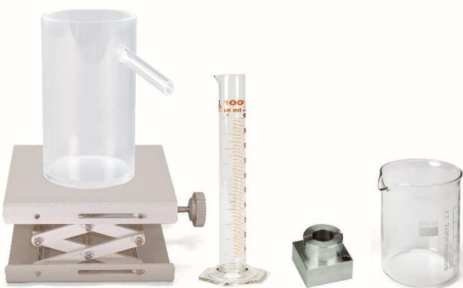
Fig. 1: Struttura per la determinazione del volume di un corpo irregolare
