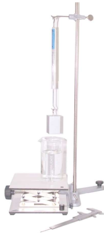
Fig. 1: Bestimmung der Auftriebskraft auf einen Quader
