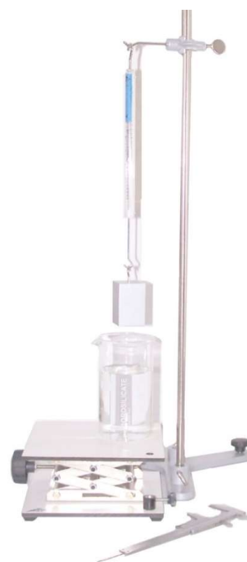
Fig. 1: Determinação da força ascensional sobre um sólido
