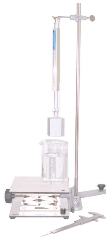
Fig. 1: Determinación del empuje ascensional sobre un paralelepípedo
