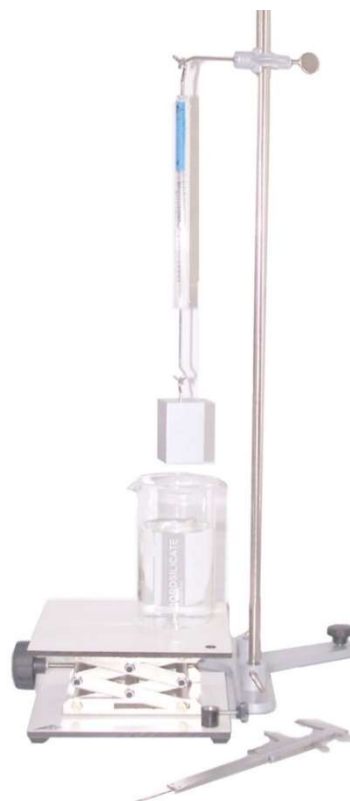
Fig. 1: Determinazione della spinta statica su un parallelepipedo
