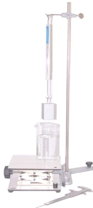
Fig. 1 : Calcul de la poussée sur un parallélépipède
