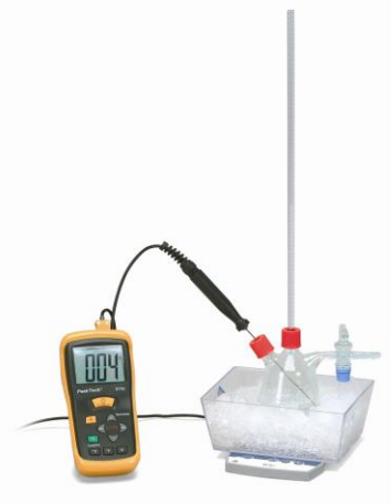
Fig. 2 : Appareillage expérimental permettant de déterminer la température pour le maximum de la densité de l'eau
