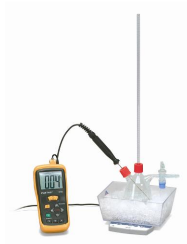
Fig. 2: Experimenteller Aufbau zur Bestimmung der Temperatur des Dichtemaximums von Wasser
