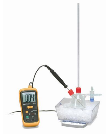
Fig. 2: Montaje experimental para la determinación de la densidad máxima del agua
