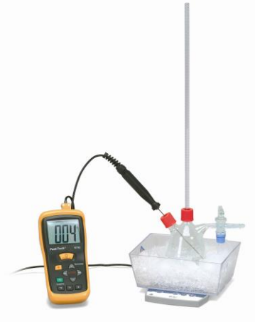
Fig. 2: Struttura sperimentale per la determinazione della temperatura del massimo di densità dell'acqua.
