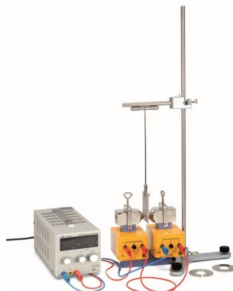
Fig. 2 Versuchsaufbau Waltenhofen'sches Pendel
