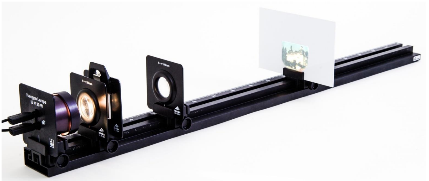
Fig. 1 Disposizione per la misurazione
