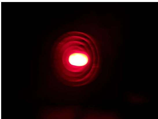
Fig. 5d: Abbildungslinse im Optikreiter verdreht. Korrektur: Abbildungslinse im Optikreiter so drehen, dass sie senkrecht zur optischen Achse ausgerichtet ist
