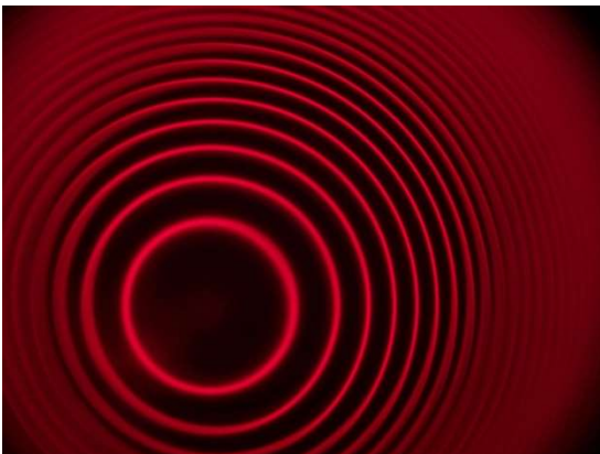
Fig. 7c: Etalon verkippt. Korrektur: Justage mit Hilfe der drei Stellschrauben am Gehäuse.
