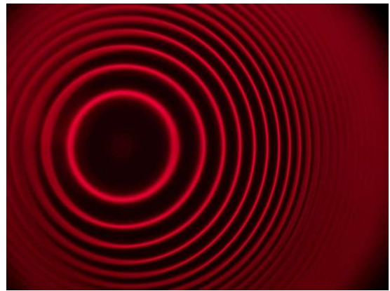
Fig. 7b: Etalon im Optikreiter verdreht. Korrektur: Etalon so im Optikreiter drehen, dass es senkrecht zur optischen Achse ausgerichtet ist
