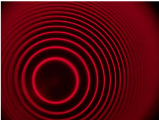
Fig. 7c: Etalon verkippt. Korrektur: Justage mit Hilfe der drei Stellschrauben am Gehäuse.
