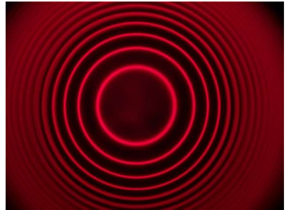
Fig. 7: Livebild mit Fabry-Pérot-Etalon
