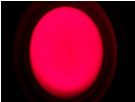
Fig. 6a: Kondensorlinse im Optikreiter verdreht. Korrektur: Kondensorlinse im Optikreiter so drehen, dass sie senkrecht zur optischen Achse ausgerichtet ist
