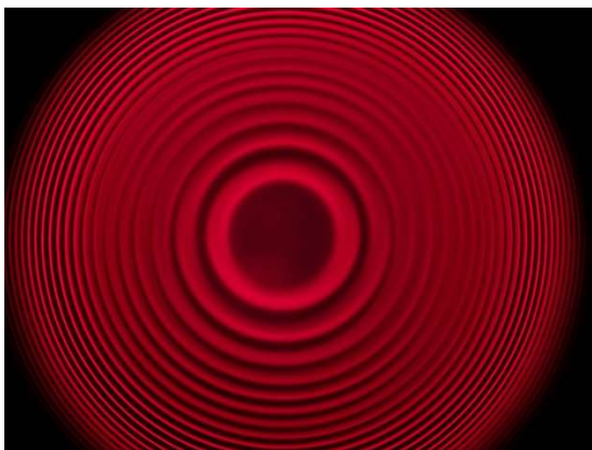
Fig. 7a: Schlechte Fokussierung. Korrektur: An der 12-mm-Linse drehen, so dass die Interferenzringe scharf zu sehen sind
