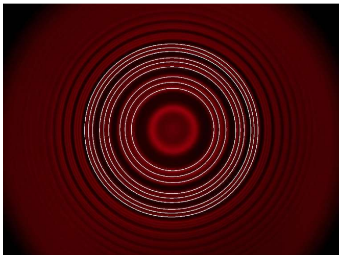
Fig. 5: Triplet-Aufspaltung der roten Cadmium-Linie ( I = 5,0 A \hat{=} B = 458 mT ). Mit Kreisen markierte Interferenzringe zur Bestimmung der eingeschlossenen Flächen
